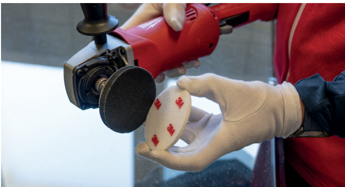
6. Zamontować na adapter SP 822 Filc polerski z talkiem, 75 mm.
