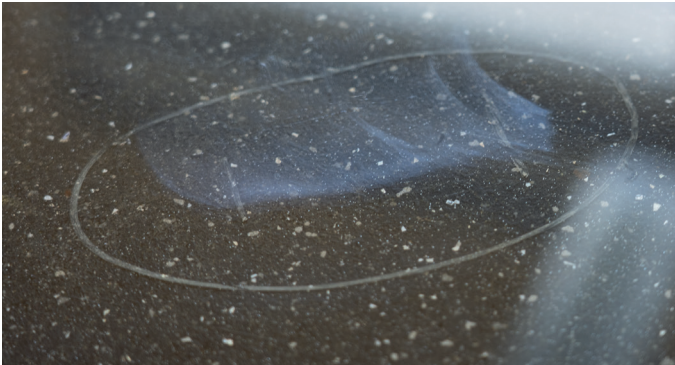
4. Rysa po obróbce polerowania.
