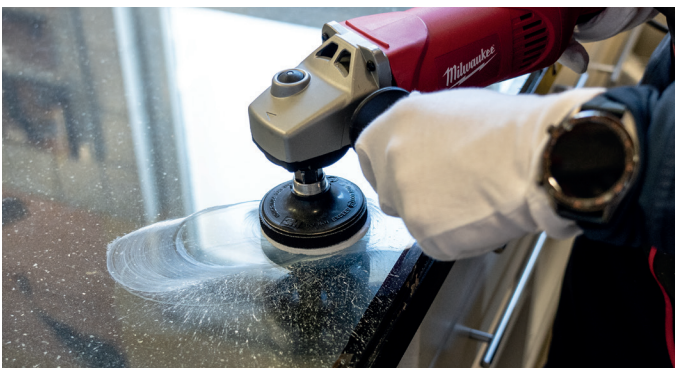
8. Polerować miejsce naprawy. Zaleca się lekkie spryskiwanie wodą miejsca polerowania, w celu zapobiegnięcia szybkiego wysychania pasty polerskiej.
